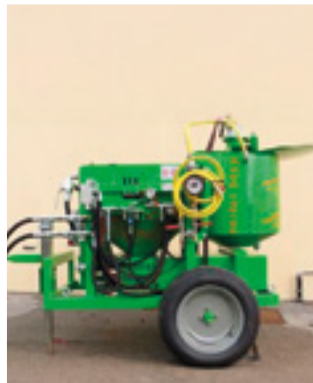
Equipos de Inyección
